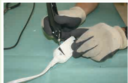
電源タップ切断
